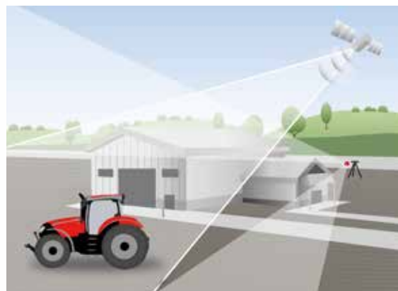
xFill bevarer forbindelsen ved RTK+ signaltab i op til 20 minutter
